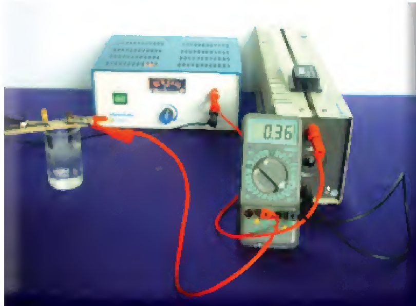
Circuit électrique série
