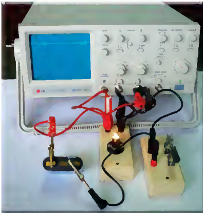
Visualisation d'une tension électrique à l'aide d'un oscilloscope
