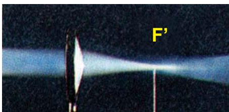
Photo.4-a Foyer image F' d'une lentille convergente
