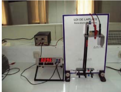
Photo 2 Sens de la force de Laplace
