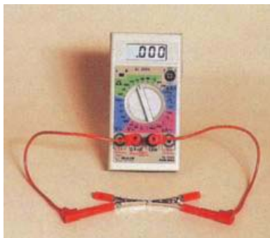
Figure 1. Mise en service et contrôle du fonctionnement de l'ohmmètre
