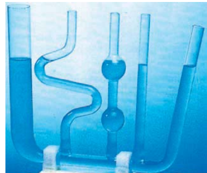
figure 6 : le niveau du liquide est le même dans les différents vases communicants.
