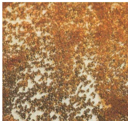
Figure 8 : Graines de résines échangeuses d'ions.
