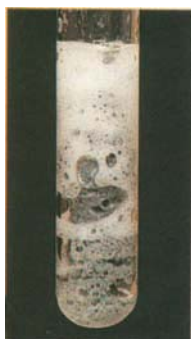
Figure 3a : Réaction entre l'acide chlorhydrique et le fer.
