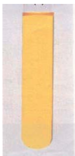
Fig. 3 : Mise en évidence de l'action des acides carboxyliques sur le BBT.
