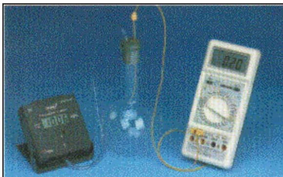
Figure 2. Dispositif expérimental pour la vérification de la loi de Charles
