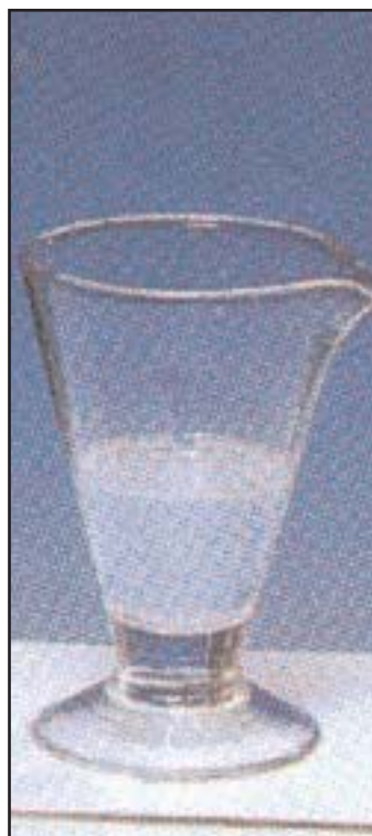
Figure 3b. Test à l'eau de chaux
