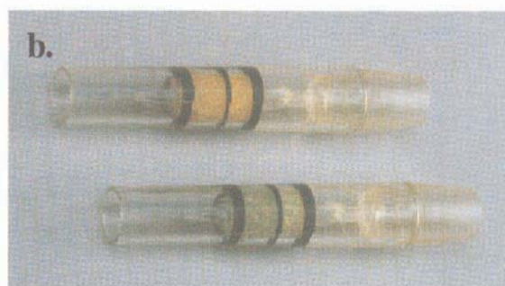
Figure 18 b. Dans le tube le réactif initialement jaune orangé vire au vert en présence d'alcool.
