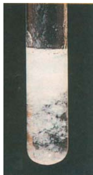
Figure. 5b. Mise en évidence des ions \text{Zn}^{2+} .
