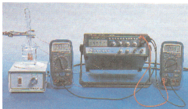
Figure 3b. Dispositif expérimental permettant de mesurer la conductance d'une solution électrolytique
