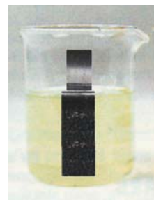
Figure 5 : Réaction du fer métallique avec les ions argent.
