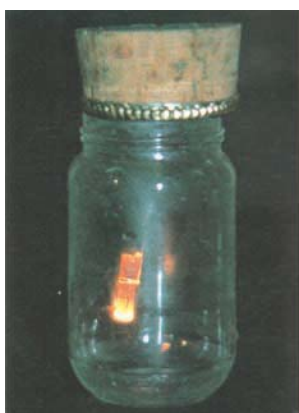
Figure 2 : Réaction du charbon avec le dioxygène pur.
