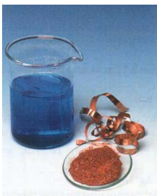
Figure 9 : Les deux formes du couple \text{Cu}^{2+}/\text{Cu} . Le cuivre \text{Cu} se présente en copeaux ou en poudre rouge. Les ions \text{Cu}^{2+} colorent en bleu une solution de sulfate de cuivre (II).
