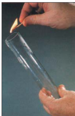
Figure 3b : Identification du dihydrogène gaz.
