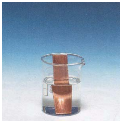
Figure 1: Le cuivre métallique ne réagit pas avec les ions fer (II)
