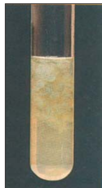
Figure 4 : Mise en évidence des ions \text{Fe}^{2+} .
