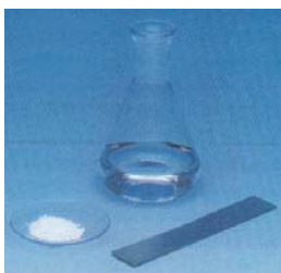
Figure 10 : Les deux formes du couple \text{Zn}^{2+}/\text{Zn} . Le zinc Zn se présente en lame ou en poudre grise. Les ions \text{Zn}^{2+} colorent en blanc une solution de sulfate de zinc (II).
