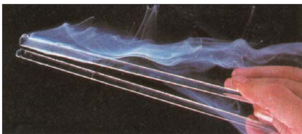
Figure 1 : Réaction du chlorure d'hydrogène \text{HCl} avec l'ammoniac \text{NH}_3
