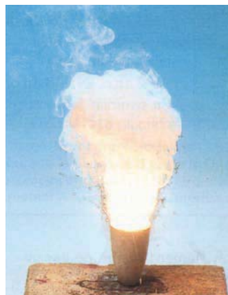
Figure 4 : Aluminothermie: réduction de l'oxyde de fer (III) par l'aluminium.
