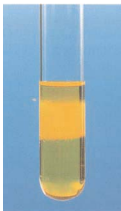
Figure. 16 : Test à la 2.4-dinitrophénylhydrazine (D.N.P.H)
