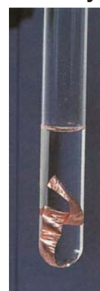
Figure 10 : L'acide chlorhydrique ne réagit pas avec le cuivre
