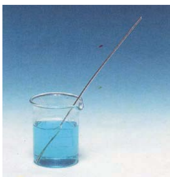
Figure 3 : L'argent métallique ne réagit pas avec les ions cuivre (II).
